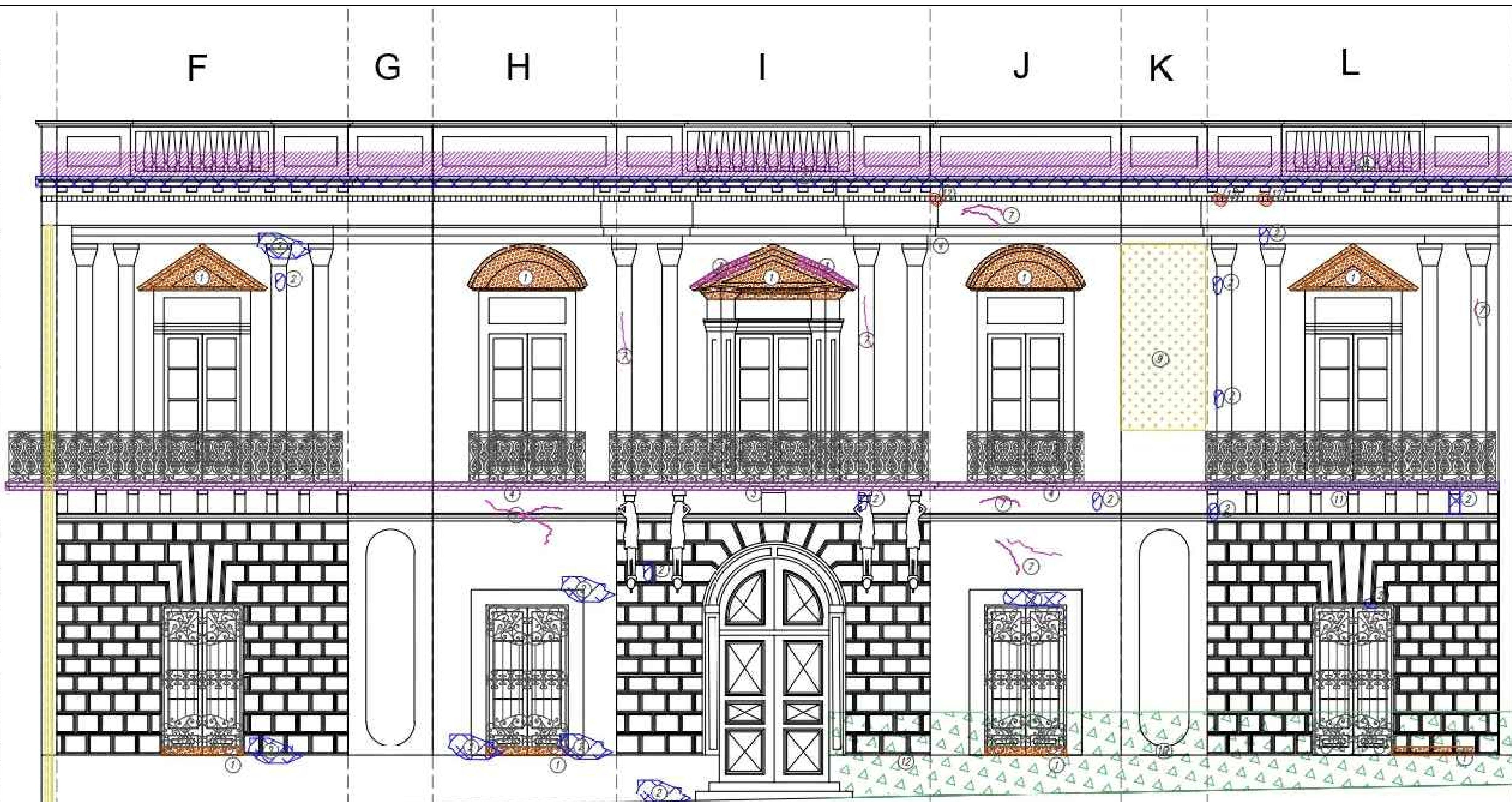
PATOLOGÍAS FACHADA SOBRE OBISPO TREJO
